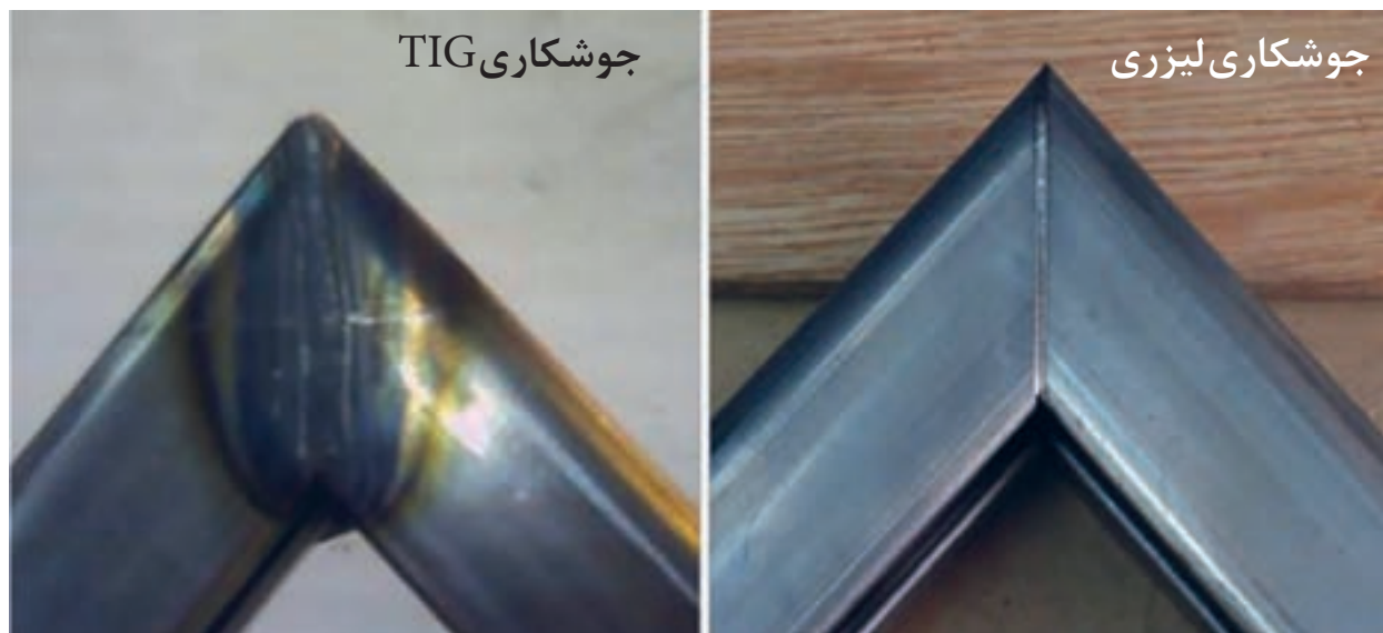
شکل ۲۳: مقایسه ابعاد منطقه متأثر از گرما (HAZ) در جوش لیزر و TIG
