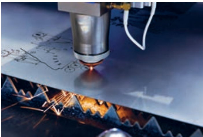
شکل ۱۹: برشکاری با پرتو لیزر
