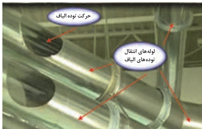
شکل ۸- لوله‌های انتقال الیاف در سیستم شوت فید
