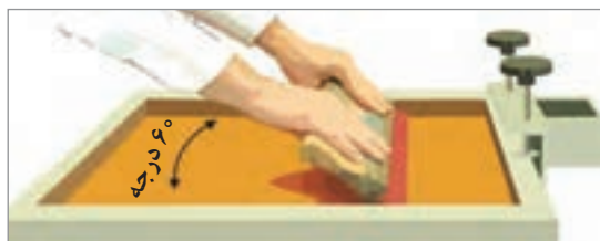
شکل ۱۶- نحوه کشیدن راکل به روش دستی
