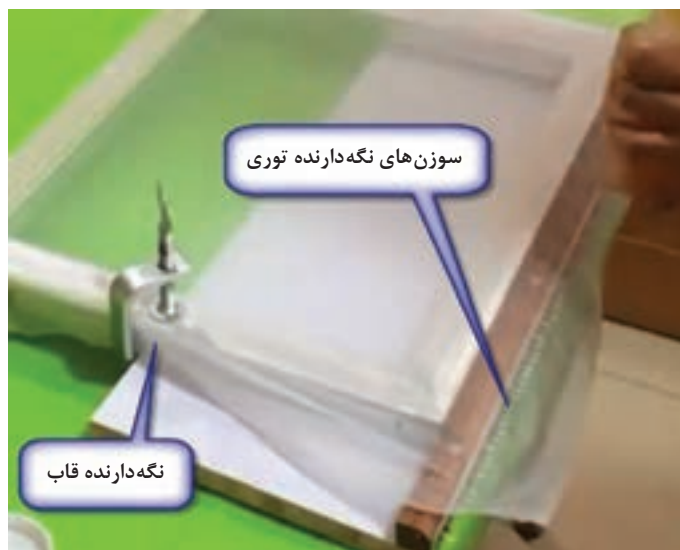
شکل ۷- توری کشی به روش دستی
