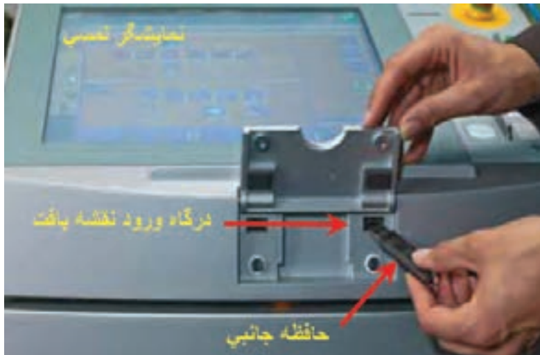
شکل ۳۷- نحوه اتصال حافظه جانبی به ماشین بافندگی
