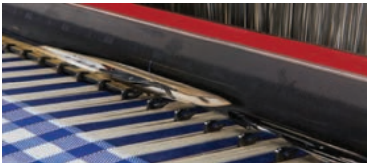
شکل ۱۷- راپیر و راهنماها و نحوه انتقال پود
