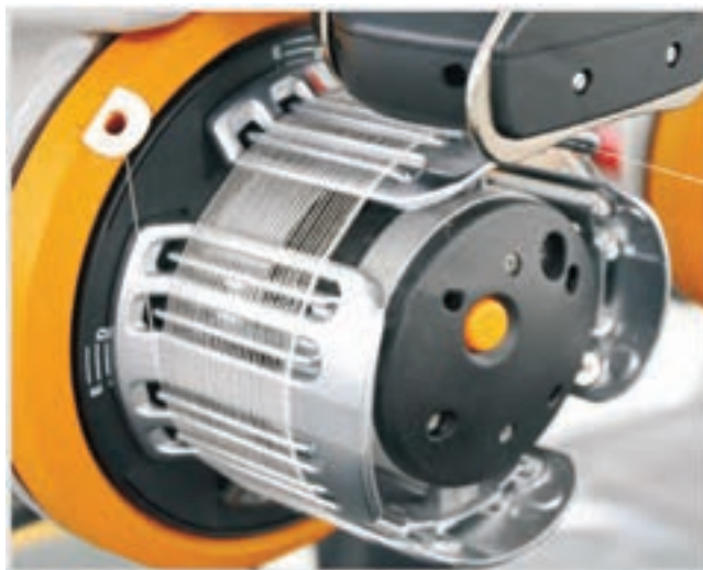
شکل ۲۸- یک مکانیزم ذخیره نخ پود استوانه‌ای
