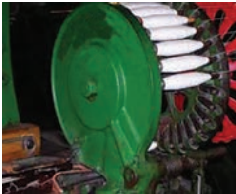
شکل ۶- مکانیزم تعویض ماسوره به همراه نمونه باتری ماسوره پُر
