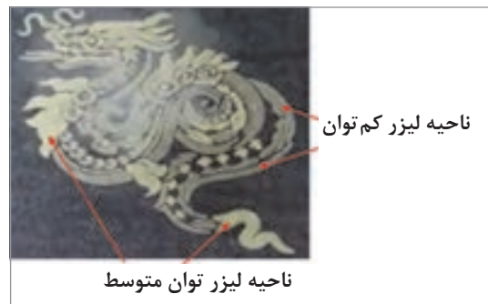
شکل ۲۹- ایجاد نقش با لیزر روی پارچه دنیتم
