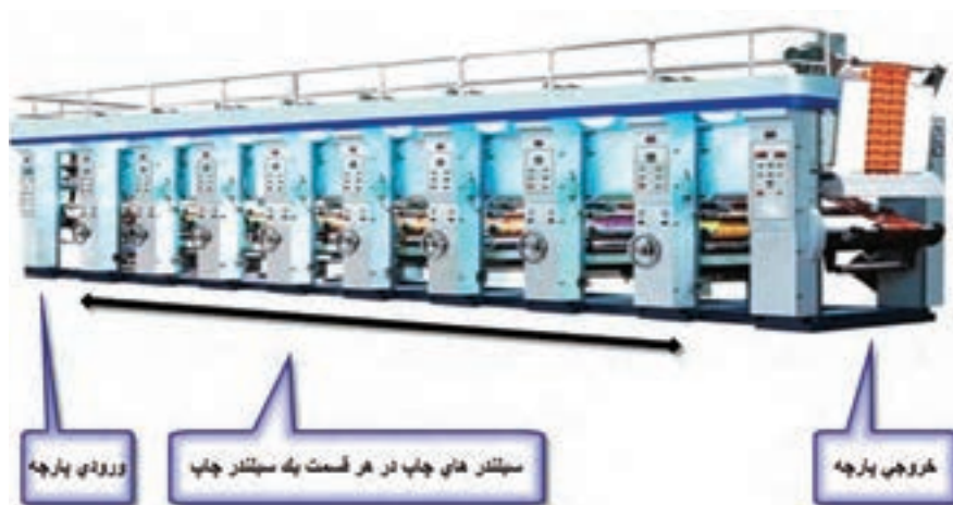
شکل ۳- نمای عملکرد ماشین چاپ غلتکی افقی
