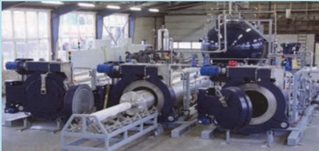
شکل ۲۵- یک نمونه ماشین رنگرزی فوق بحرانی CO 2
