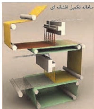
شکل ۱۳- دو سامانه نانومقیاس تولید و تکمیل افشانه‌ای نانوذرات بر روی پارچه
