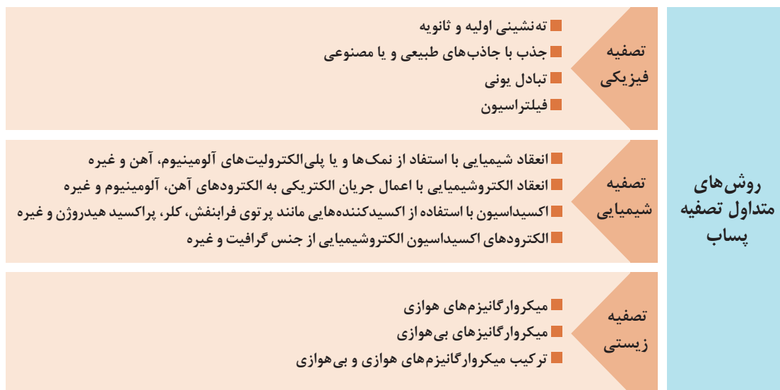
شکل ۱۸- روش‌های متداول تصفیه پساب در صنعت نساجی
