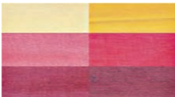
شکل ۱۲- افزایش قابلیت رنگ پذیری ابریشم تکمیل شده با نانوذرات کیتوسان
