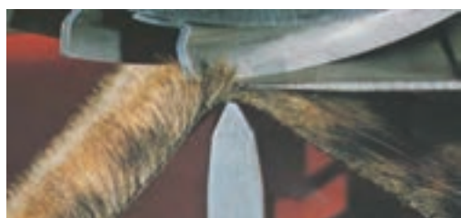
شکل ۷- تصویر تیغه مارپیچی و ماشین تراش پارچه
