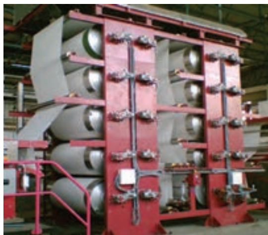
شکل ۱۴- تصویر خشک‌کن سیلندری یا غلتکی عمودی
