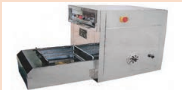
شکل ۱- تصویر استنتر آزمایشگاهی
