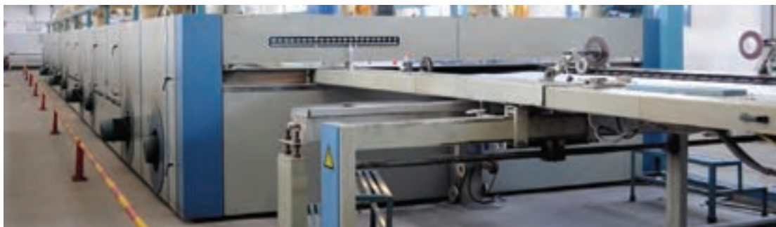
شکل ۱۶- تصویر یک عدد ماشین استنتر
