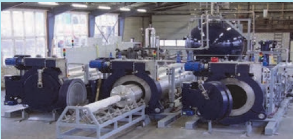
شکل ۲۵- یک نمونه ماشین رنگرزی فوق بحرانی CO 2
