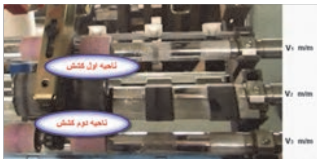
شکل ۲۳- نواحی کشش در رینگ
