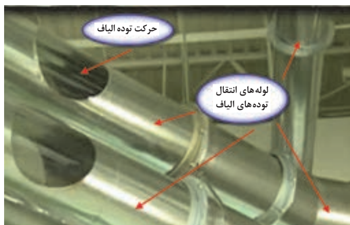
شکل ۸- لوله‌های انتقال الیاف در سیستم شوت فید
