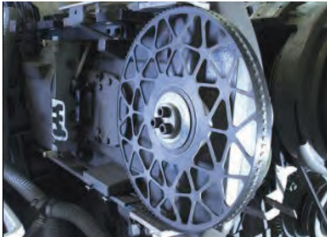
شکل ۱۹- غلتک دوران کننده و محرک راپیر
