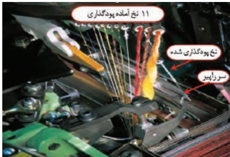
شکل ۲۰- سیستم تغییر پود در پودگذاری راپیری
