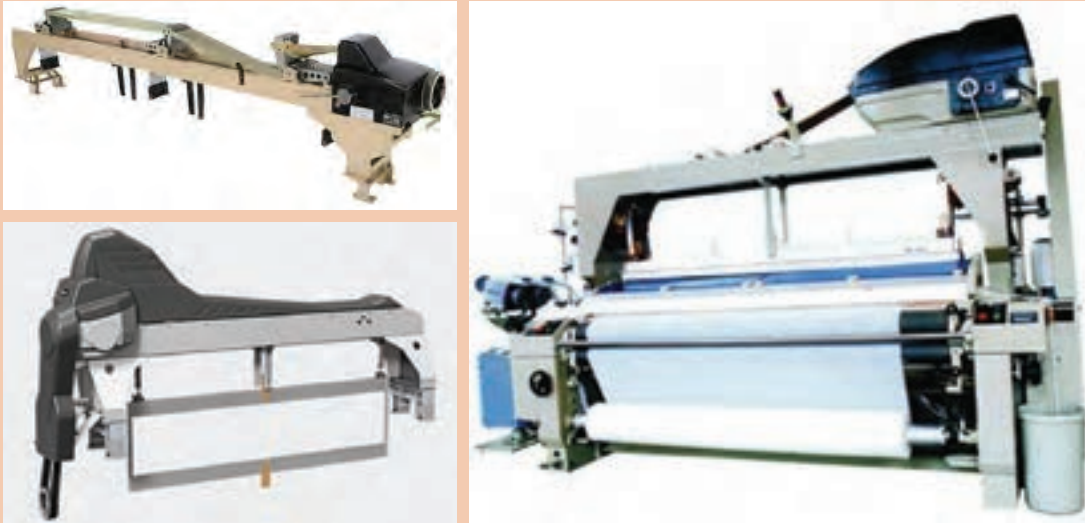
شکل ۱۴- یک دستگاه ماشین بافندگی با سیستم تشکیل دهنه دابی و یک دستگاه دابی
