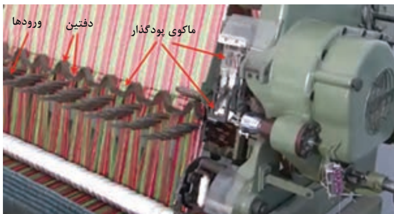
شکل ۲۹- بخش پودگذاری پی در پی ماشین بافندگی چند فازی
