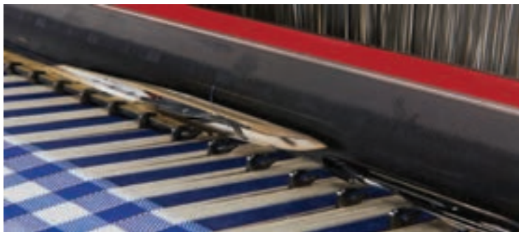
شکل ۱۷- راپیر و راهنماها و نحوه انتقال پود
