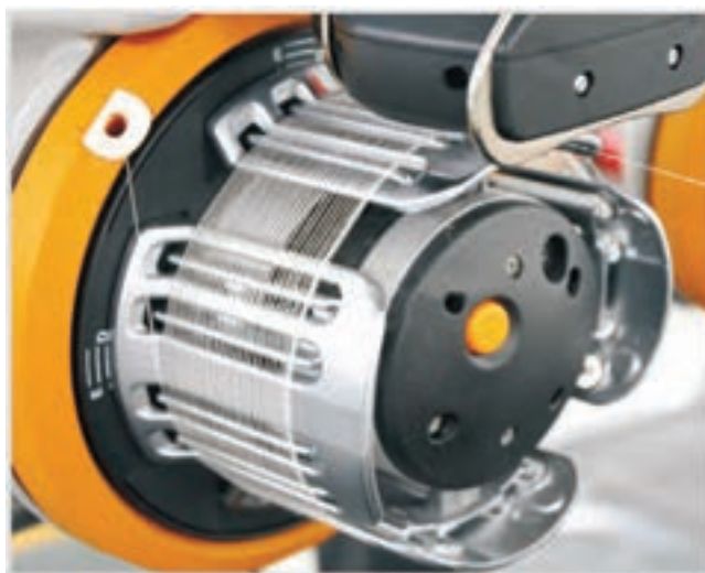
شکل ۲۸- یک مکانیزم ذخیره نخ پود استوانه‌ای
