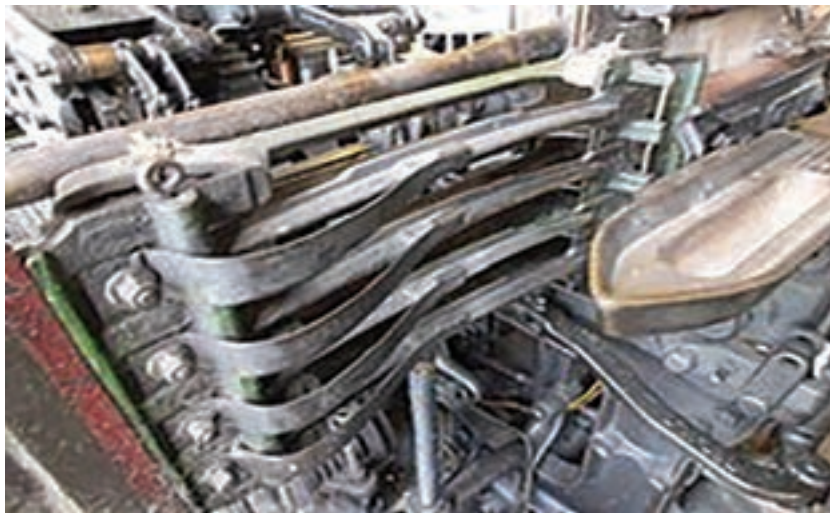
شکل ۹- چهار جعبه ماکو در یک ماشین بافندگی
