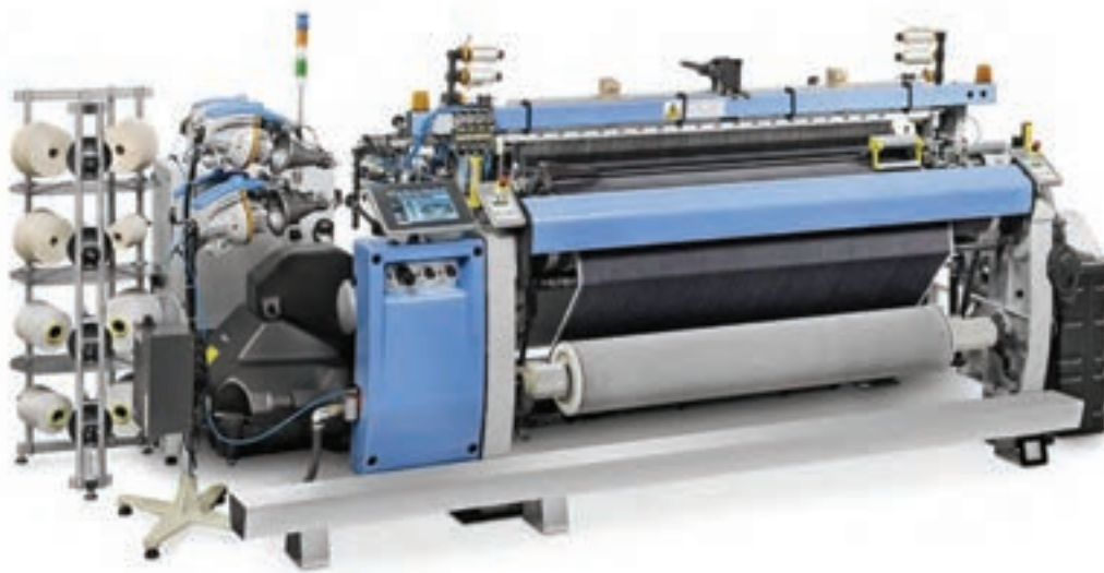
شکل ۲۱- یک دستگاه بافندگی با مکانیزم ایرجت
