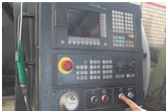
شکل ۱۹- روشن کردن سیستم هیدرولیک دستگاه
