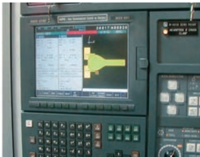
شکل ۲۸- آزمایش برنامه در محیط گرافیکی
