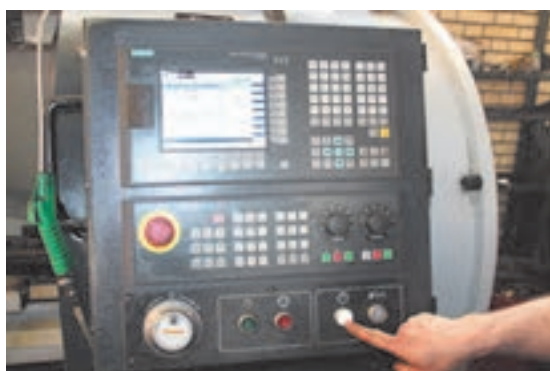
شکل ۲۱- زدن مجدد کلید سیستم هیدرولیک
