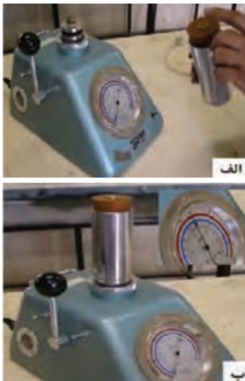
شکل ۳۳- مراحل انجام آزمایش قابلیت نفوذ گاز
