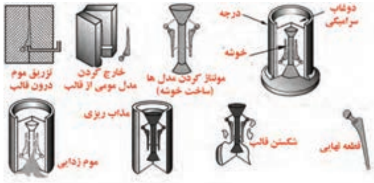
شکل ۲۳- مراحل مختلف ریخته‌گری دقیق به روش توپر
