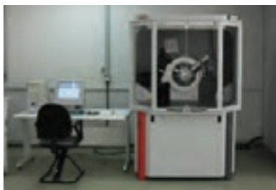
شکل ۹- دستگاه آنالیز اشعه X جهت بررسی ساختار شبکه‌ای فلزات
