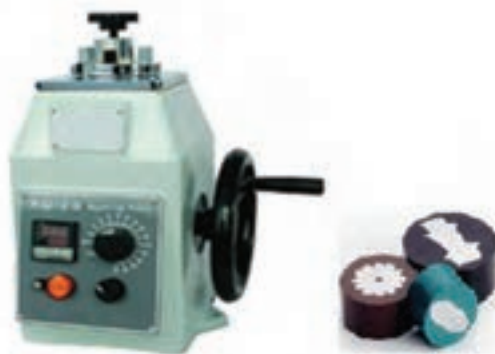
شکل ۱۳- دستگاه مانت گرم و نمونه‌های مانت شده
