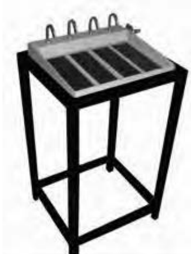
شکل ۱۲- صفحه‌های صاف سنباده کاری نمونه‌های متالوگرافی
