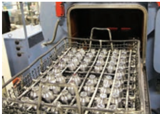
شکل ۲۱- قرارگیری سبد حاوی قطعات جلوی درب کوره
