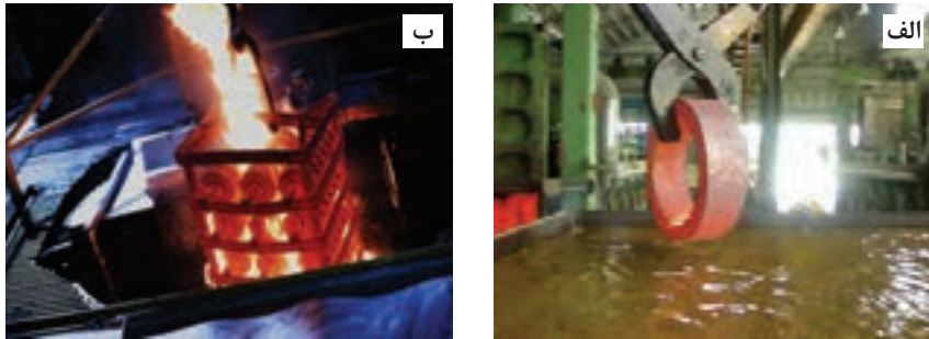
شکل ۲۸- وارد کردن قطعات به محیط خنک کننده
