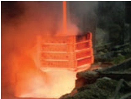
شکل ۳۶- کربوره کردن مایع در حمام نمک
