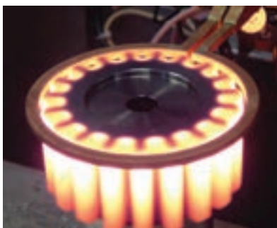
شکل ۳۹- سخت کردن چرخ دنده به روش اینداکشن
