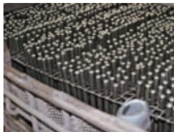
شکل ۲۰- انواع چیدمان قطعات در سبدها و روی صفحه فولادی
