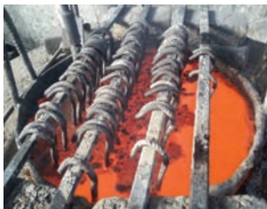
شکل ۲۵- وارد کردن قطعات سیم‌بندی شده در حمام نمک
