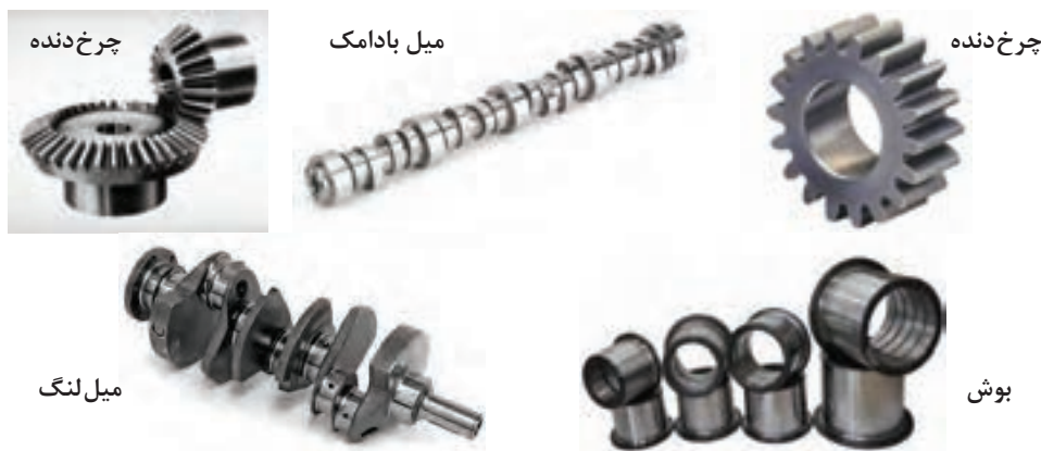
شکل ۳۲- انواع قطعاتی که تحت عملیات سخت کاری سطحی قرار می گیرند.
