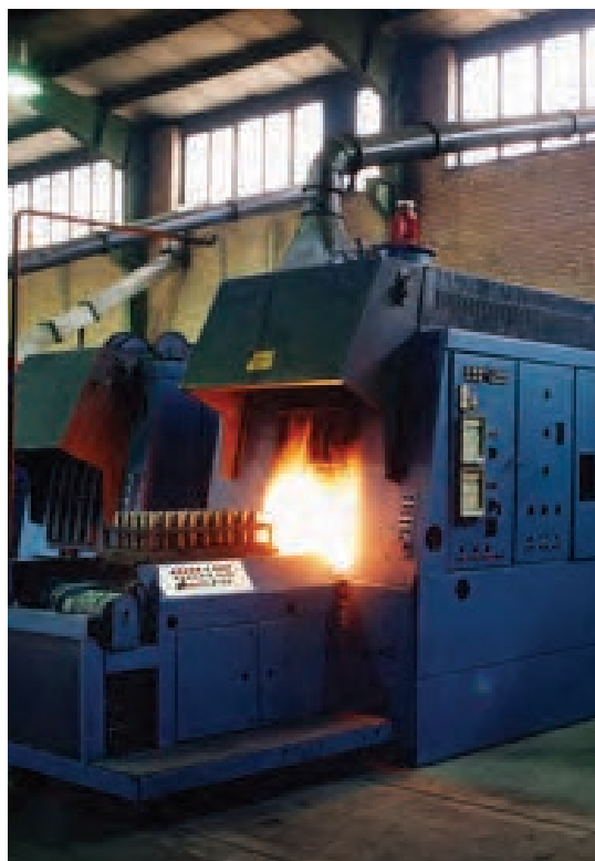
شکل ۳۷- کوره کربورایزینگ گازی
