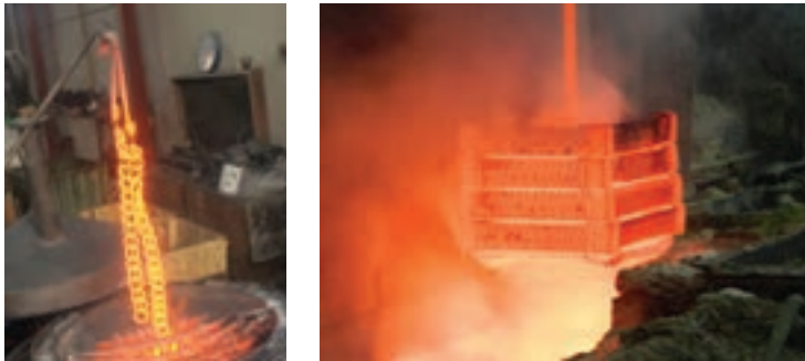
شکل ۲۷- روش های مختلف خارج کردن قطعه از کوره
