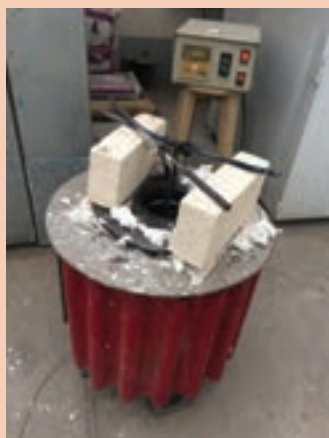
شکل ۳۰- وارد کردن نمونه‌ها در حمام نمک
