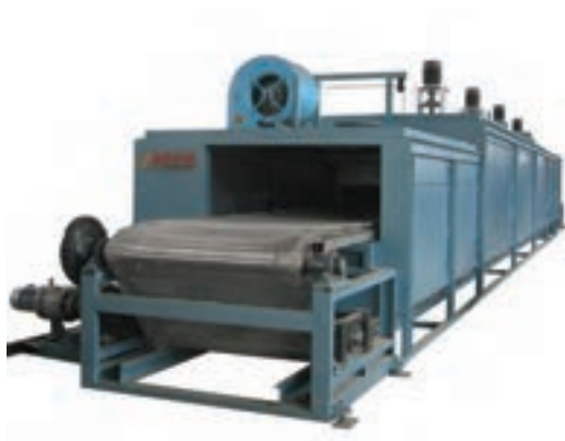
شکل ۹- کوره عملیات حرارتی مداوم
