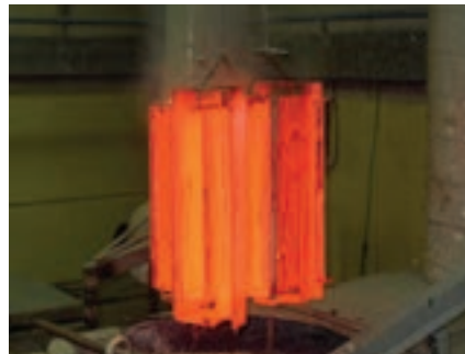
شکل ۳۶- کربوره کردن مایع در حمام نمک
