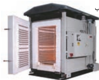
شکل ۵- انواع کوره‌های الکتریکی، الف) بدون فن، ب) فن دار
