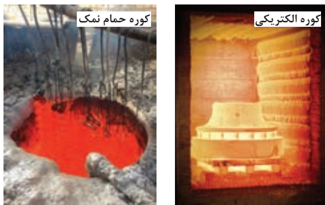
شکل ۲۶- هم‌دما کردن قطعات در کوره‌ها
