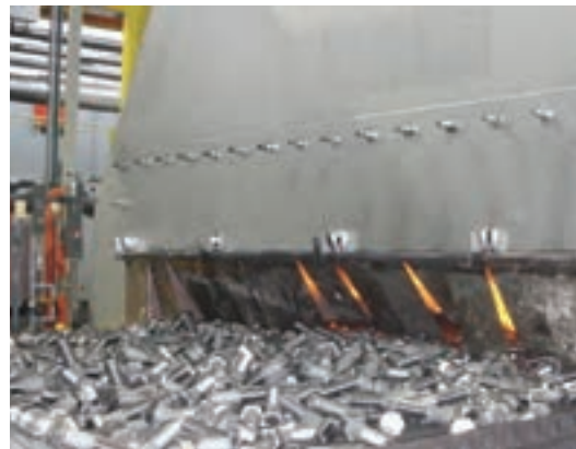
شکل ۹- کوره عملیات حرارتی مداوم
