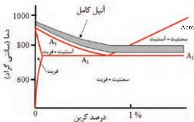
شکل ۱- محدوده دمایی آنیل کامل در فولادها (منطقه خاکستری رنگ)
