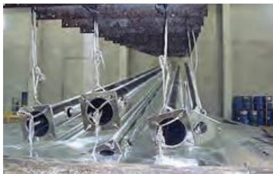
شکل ۱۳- تصاویری از پوشش دهی فلزات به روش غوطه‌وری که داخل روی مذاب غوطه‌ور می‌شوند.
