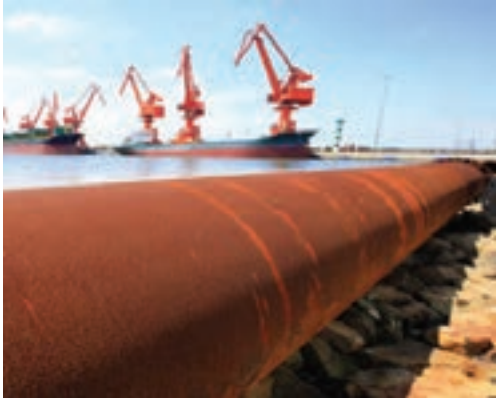
شکل ۴-لوله فولادی که تحت خوردگی یکنواخت قرار گرفته.
