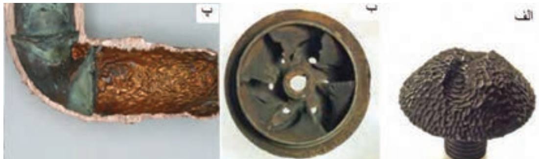
شکل ۱۰- الف) پیچ در محلول خورنده حاوی ذرات ساینده دچار خوردگی فرسایشی شده است. ب) پره پمپ به دلیل قرار گرفتن در محلول خورنده حاوی ذرات ماسه دچار خوردگی فرسایشی شده است. پ) لوله فولادی که در اثر وجود سیال داخل آن دچار خوردگی فرسایشی شده است.
