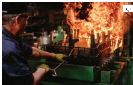
شکل ۲۲- نمونه‌ای از ورود قطعات در کوره‌ها با اتمسفر کنترل شده، الف) روشن شدن مشعل درب کوره هنگام وارد کردن قطعات، ب) بسته شدن درب کوره بعد از وارد شدن قطعات
