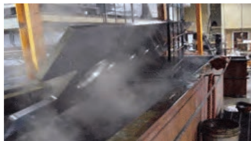
شکل ۲۰- تصویری از عملیات سیاه کاری
