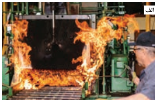
شکل ۲۲- نمونه‌ای از ورود قطعات در کوره‌ها با اتمسفر کنترل شده، الف) روشن شدن مشعل درب کوره هنگام وارد کردن قطعات، ب) بسته شدن درب کوره بعد از وارد شدن قطعات
