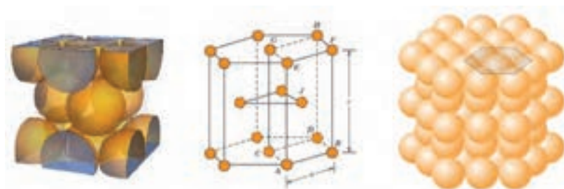
شکل ۶- ساختار هشت وجهی هگزاگونال (HCP) مربوط به فلزاتی مانند روی، برلیوم، زیرکینیم، کبالت و غیره
