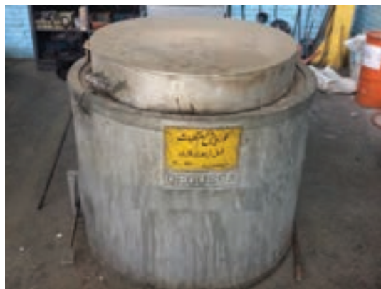
شکل ۲۴- کوره پیش‌گرم قطعات
