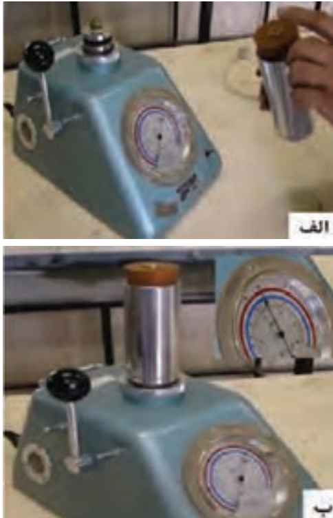
شکل ۳۳- مراحل انجام آزمایش قابلیت نفوذ گاز
