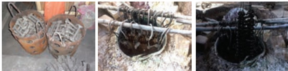
شکل ۳۱- تمپر کردن قطعات
