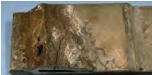
شکل ۱۰- الف) پیچ در محلول خورنده حاوی ذرات ساینده دچار خوردگی فرسایشی شده است. ب) پره پمپ به دلیل قرار گرفتن در محلول خورنده حاوی ذرات ماسه دچار خوردگی فرسایشی شده است. پ) لوله فولادی که در اثر وجود سیال داخل آن دچار خوردگی فرسایشی شده است.
