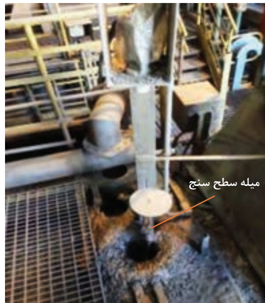
محل قرارگیری سطح سنج مکانیکی در یک سلول فلوتاسیون محل قرارگیری شیرهای تخلیه درون یک سلول (کف سلول)
