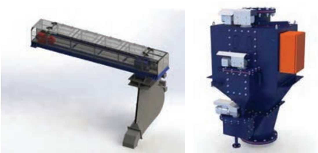
شکل ۳۷- تجهیزات ثابت نمونه‌گیری از بار اولیه، محصول و باطله نهایی
