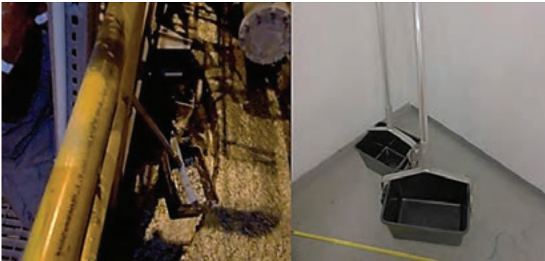
شکل ۳۴- تجهیزات نمونه‌گیری از سرریز سلول فلوتاسیون
