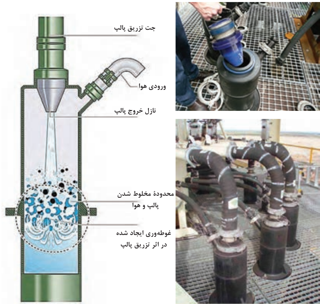
شکل ۲۲- جت‌های تزریق پالپ در سلول فلوتاسیون جیمسون
