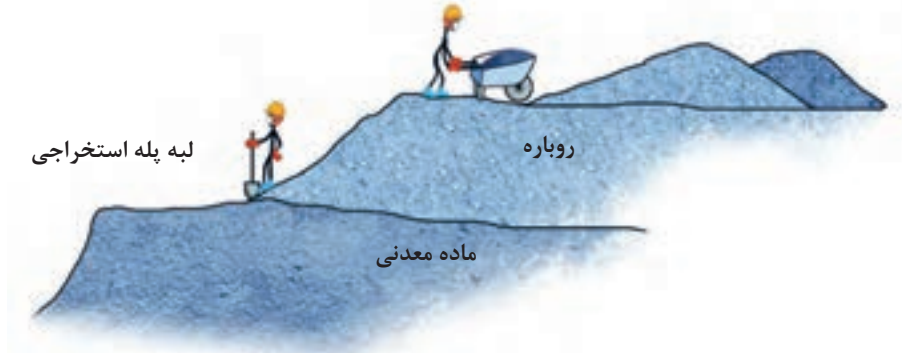
نحوه برداشت روباره در معادن روباز
