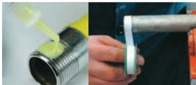
لوازم آب‌بندی اتصالات و لوله‌ها
