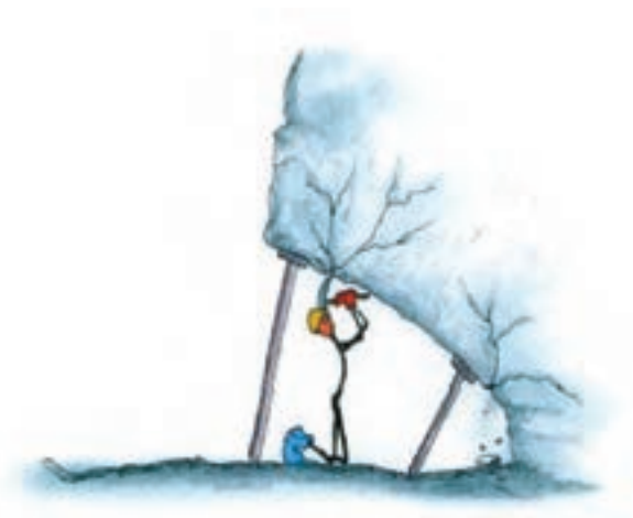
ایجاد زیر برش با نصب وسیله نگهدارنده
