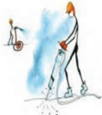
استفاده از اسپری آب جهت کاهش گردوغبار
