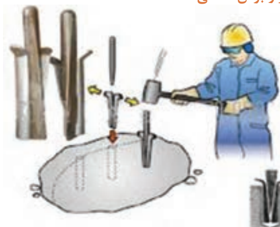
پاس و گوه و انجام عملیات چکش کاری جهت برش سنگ
