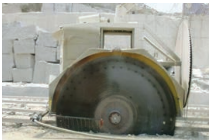
دستگاه دیسک برنده در حال برش سنگ
