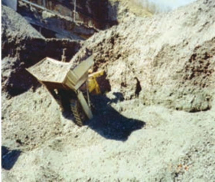
ریزش خاک‌های نرم بر روی ماشین معدنی
