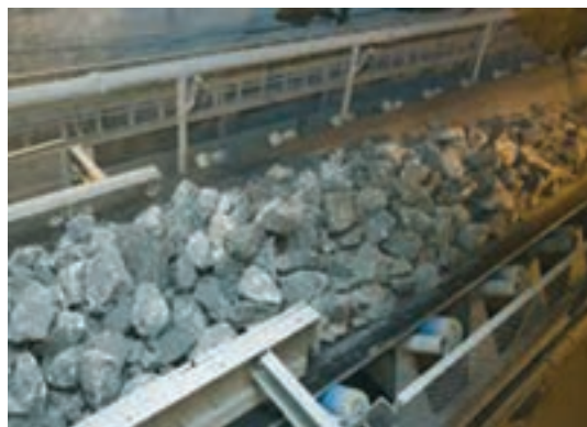
حمل مواد معدنی فلزی زیر زمینی از طریق نوار نقاله و واگن
