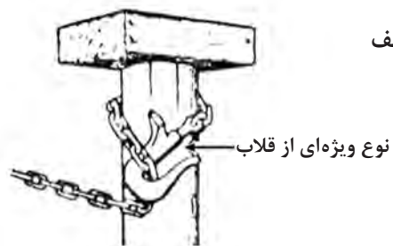
الف) نحوه بستن قلاب به دور پایه
