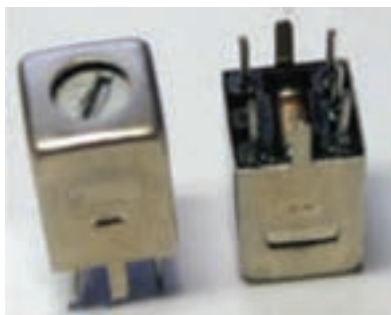
ترانس IF و خازن داخل آن
