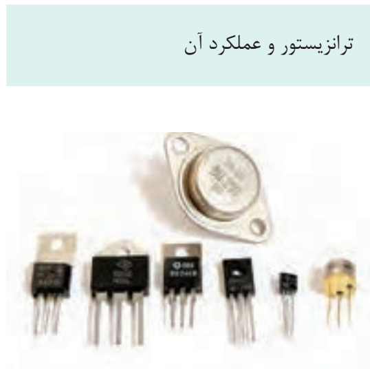
شکل ۲۲- انواع ترانزیستور و نحوه عملکرد آن
