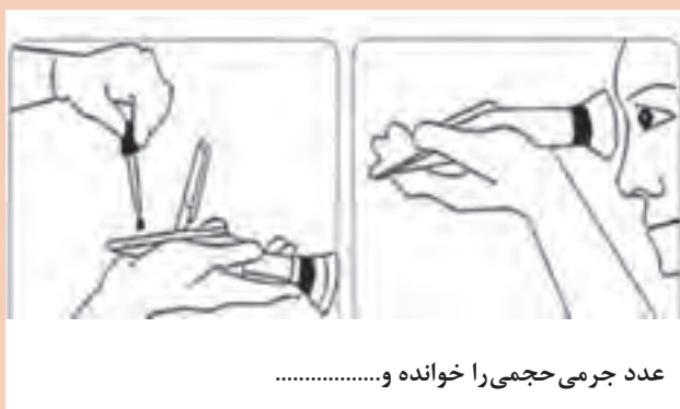
شکل ۴۹- نحوه استفاده از هیدرومتر و رفلکتومتر برای اندازه گیری جرم حجمی الکترولیت باتری
