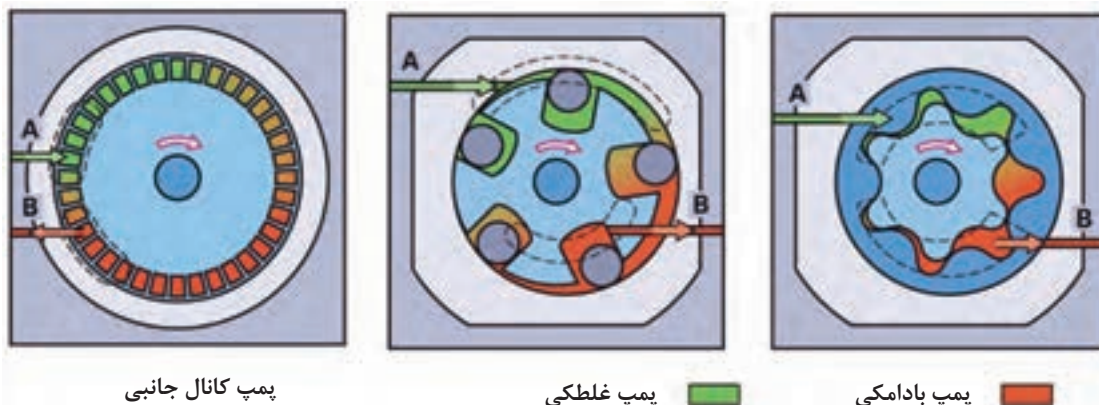
شکل ۲۰- پمپ بنزین بیرون باک و داخل باک
