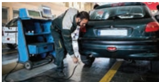
شکل ۶۶- قرارگیری لوله دستگاه کنترل آلاینده‌گی روی لوله اگزوز
