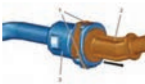
شکل ۷۴- نمونه‌ای از اتصالات سریع در مجموعه شیلنگ‌های سوخت
