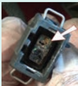
شکل ۶۲- یک نمونه سوکت معیوب
