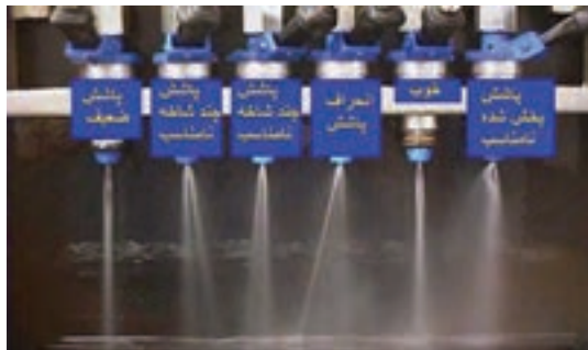
شکل ۷۸- انواع احتمالی پاشش سوخت در انژکتور
