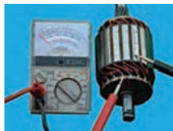
– آزمایش اتصال بدنه آرمیچر
