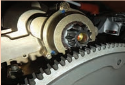
شکل ۱۰۰-ارتباط دنده فلاپیول با دنده استارت
