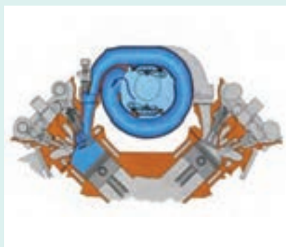
شکل ۴۱- عملکرد سیستم TUMBLE
