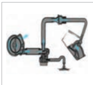
پمپ تزریق ثانویه اسماگ
