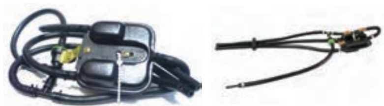
شکل ۶- ساختمان سیستم حباب گیر بنزین
