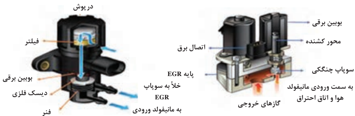
شکل ۱۶- شیر برقی EGR مدل بیرونی و داخلی
