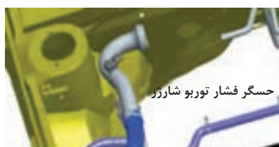
شکل ۳۲- موقعیت حسگر فشار توربو شارژر
