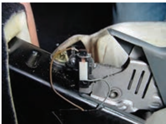
شکل ۲۴- میکرو سوییچ ترمز دستی و محل بستن آن
