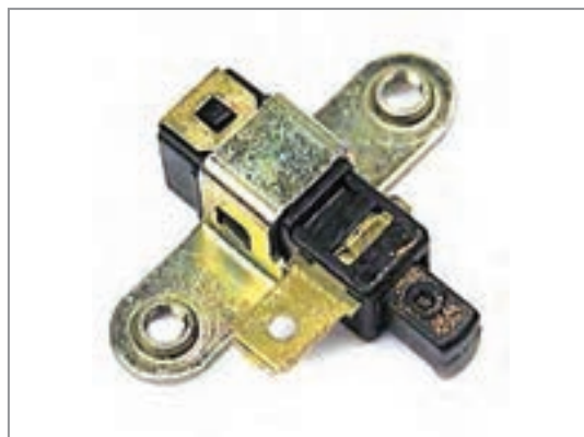
شکل ۲۴- میکرو سوییچ ترمز دستی و محل بستن آن
