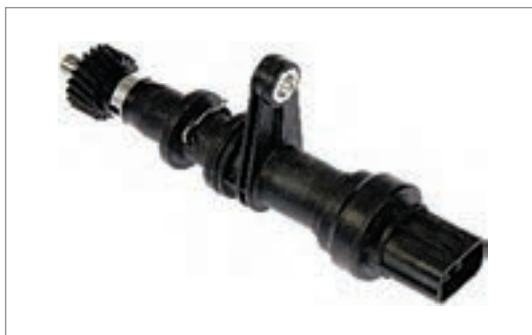
شکل ۱۶- حسگر سرعت خودرو از نوع القایی
