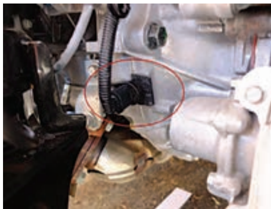
شکل ۱۸- حسگر دور موتور و محل بستن آن
