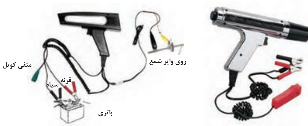
شکل ۲۰- نوعی چراغ تایمینگ و روش اتصال آن به سیم‌کشی خودرو
