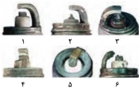
شکل ۳۲- بررسی عیوب متداول سیستم جرقه و سوخت از روی وضعیت الکتروود شمع
