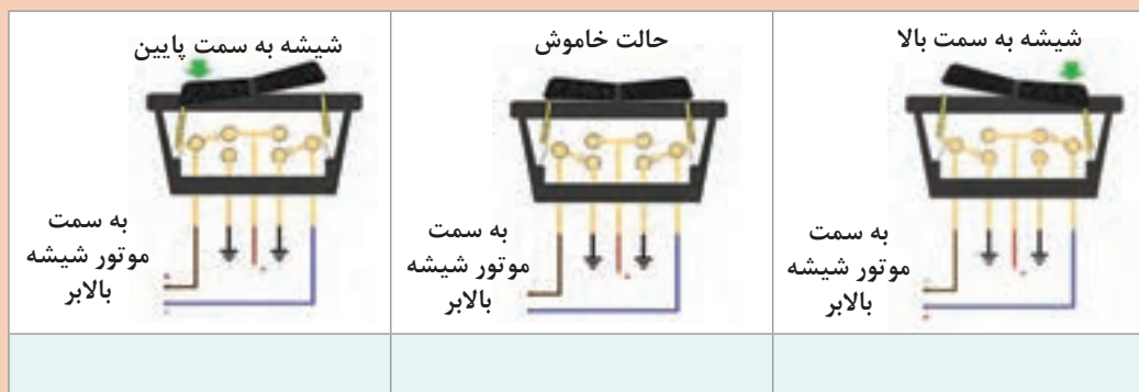
شکل ۶- عملکرد کلید شیشه بالابر الکتریکی
