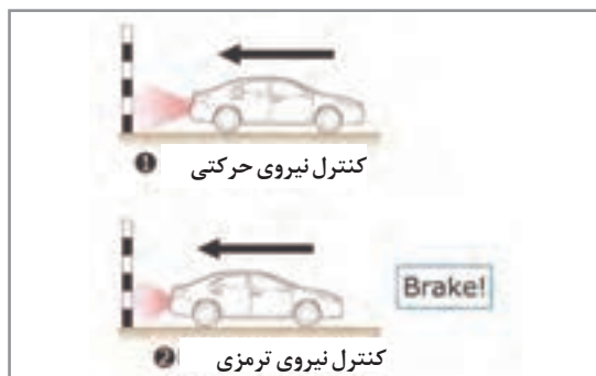
شکل ۴- عملکرد ترمز اتوماتیک با کمک سنسور دنده عقب
