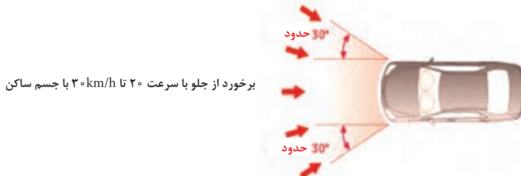
شکل ۵۴- شرایط برای فعال کردن کیسه هوای ایمنی (در مورد برخورد از جلوی خودرو)
