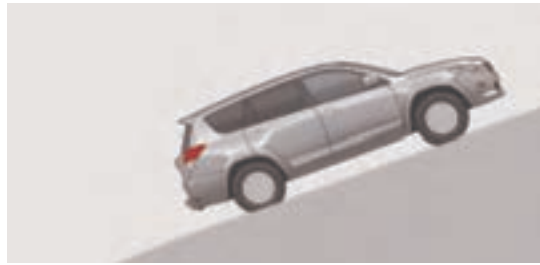
شکل ۲۵- سیستم HAC کمک می‌کند تا کنترل پایداری شیب‌دار را افزایش دهد و از پس روی خودرو جلوگیری کند.
