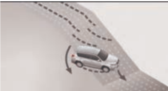
شکل ۲۸- خودرو فاقد سیستم DAC، در سراسیمگی‌های تند در زمان ترمزگیری چرخ‌ها را قفل می‌کنند.
