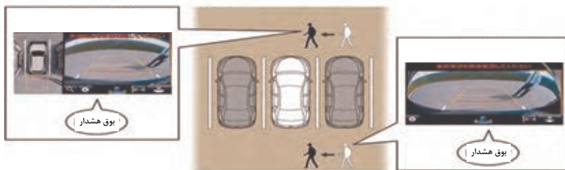
شکل ۱۳- سیستم‌های کمکی وجود عابر پیاده را در مسیر حرکت خودرو به راننده اطلاع می‌دهند.
