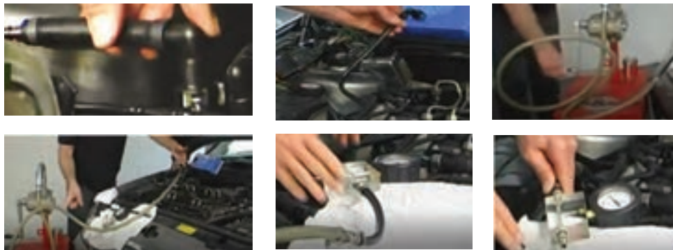
شکل ۵۴ - بازدید، بررسی و تعویض فیلتر سوخت
