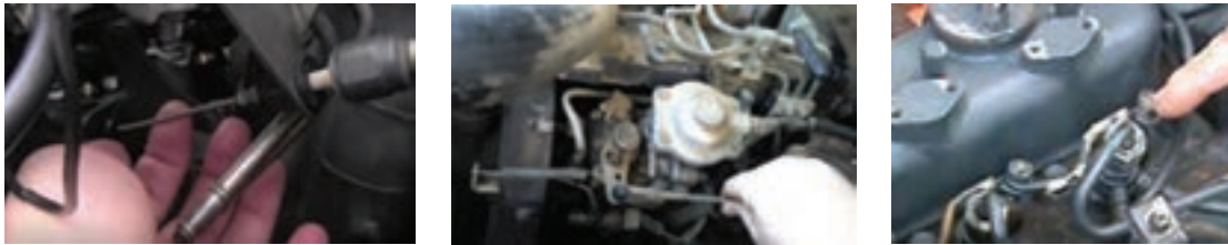
شکل ۶۰- بازدید، بررسی و تنظیم اهرم‌بندی گاز و خاموش کن
