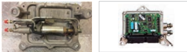
شکل ۷۲- واحد کنترل الکترونیکی ECU با مجاری عبور سوخت جهت خنک کاری ECU
