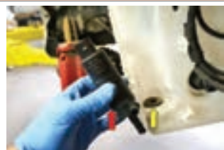
شکل ۳۱- مراحل تعویض پمپ شیشه شوی
