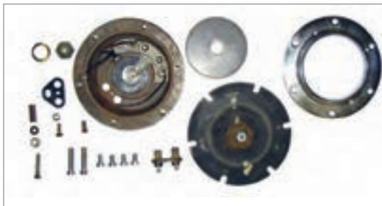
شکل ۴۷- اجزای داخلی بوق الکترومغناطیسی
