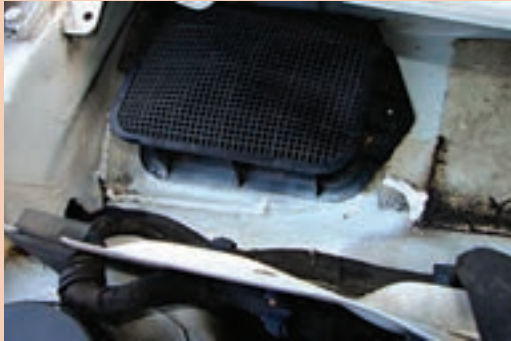
شکل ۲۱- اثر گرفتگی مجرا و عدم تخلیه
