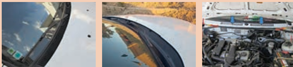
شکل ۲۰- انتقال آب روی سطح شیشه جلو خودرو
