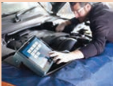
شکل ۵۵- استفاده از دستگاه عیب‌یاب
