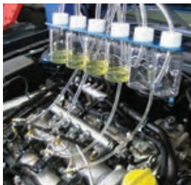
شکل ۵۸- تست اندازه‌گیری مقدار سوخت برگشتی انژکتورها
