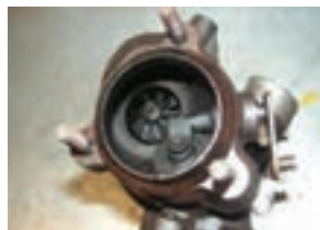
شکل ۸۷- نشت روغن در توربوشارژر
