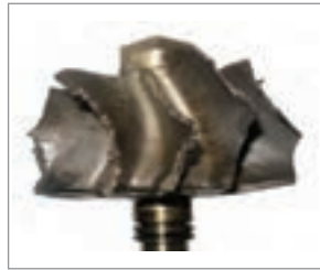
شکل ۸۶- خرابی پره‌های توربوشارژر در اثر برخورد با جسم خارجی
