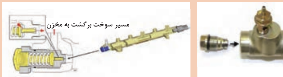
شکل ۳۷- سوپاپ کنترل فشار مکانیکی در تزریق ریل مشترک
