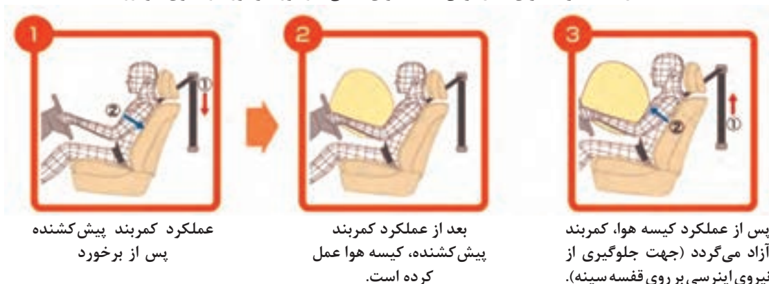
شکل ۵۵- نتیجه عملکرد همزمان کمربند ایمنی و کیسه هوای ایمنی
