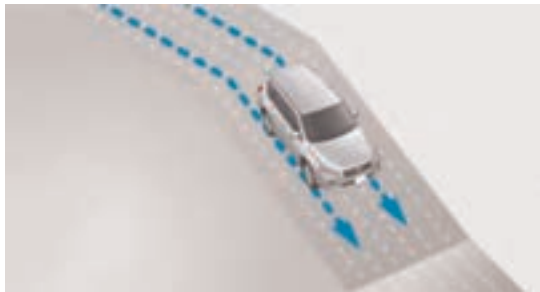
شکل ۲۷- سیستم DAC در حین حرکت رو به پایین بر روی سطوح شیب‌دار و لغزنده کنترل خودرو را بهبود می‌بخشد.
