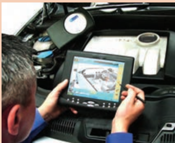
شکل ۷۹- نصب انژکتور الکترومکانیکی جدید توسط دستگاه عیب‌یاب
