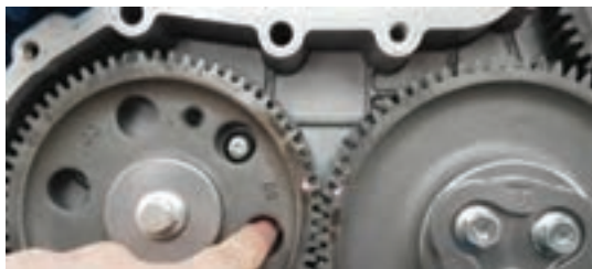
شکل ۶۰- بررسی تایم پاشش سوخت
