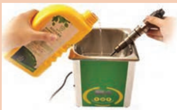
شکل ۸۲- تمیز کردن سوراخ انژکتور با دستگاه اولتراسونیک
