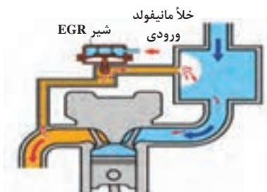
شکل ۱۹- مسیر عبور گازهای خروجی خلأی
