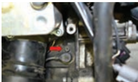
باز کردن شیر کنترل پمپ دمنده
