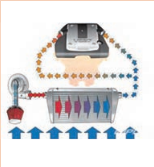
خنک کننده هوای ورودی توسط هوا
