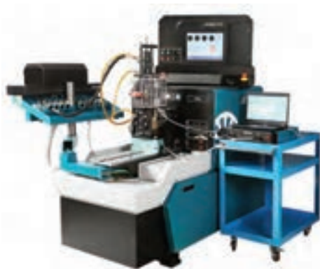
شکل ۷۲- برخی از مراحل آزمایش و تنظیم یک نوع انژکتور واحد
