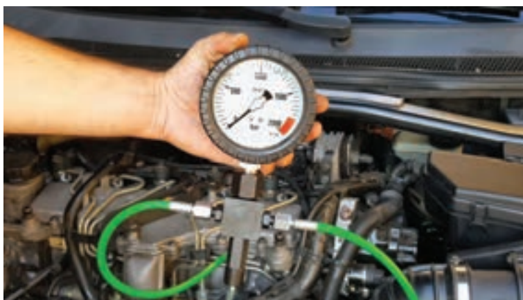
شکل ۵۹- بررسی فشار مدار سوخت‌رسانی دیزل به وسیله ابزار اندازه‌گیری
