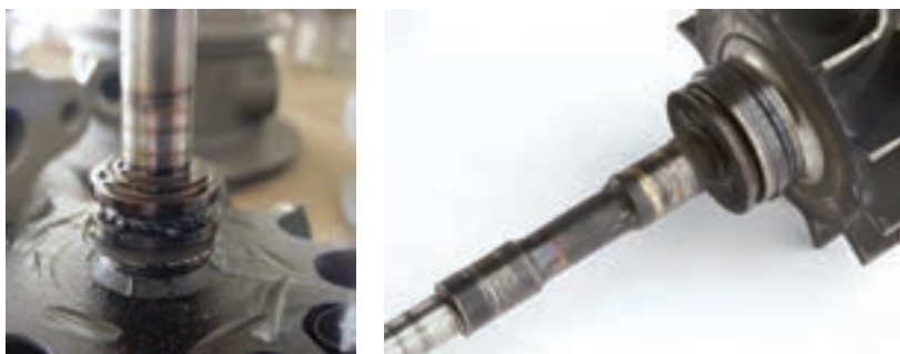
شکل ۸۹- خرابی یاتاقان‌ها و محور توربوشارژر
