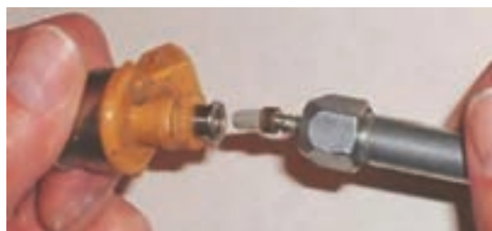
شکل ۸۰- تعویض فیلتر انژکتور
