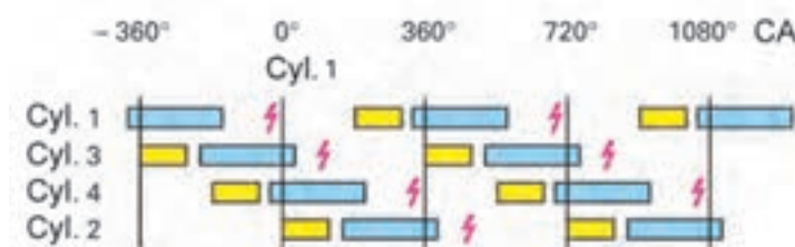
شکل ۲۸- پاشش ترتیبی انژکتورها
