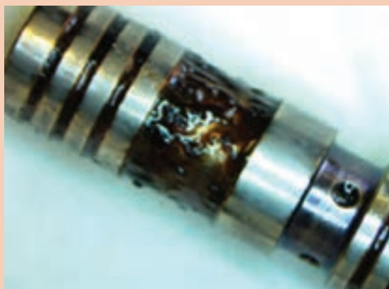
شکل ۸۰- خرابی انژکتور در اثر آب در سوخت
