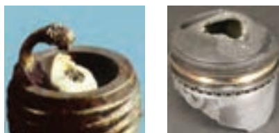
شکل ۳- آسیب به پیستون و شمع بر اثر احتراق پیش‌رس و خودسوزی
