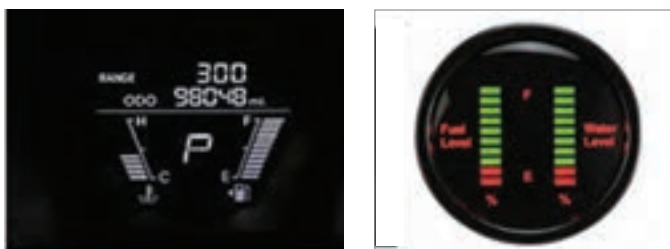
شکل ۱۵- نمایشگر سوخت دیجیتالی (میله ای)
