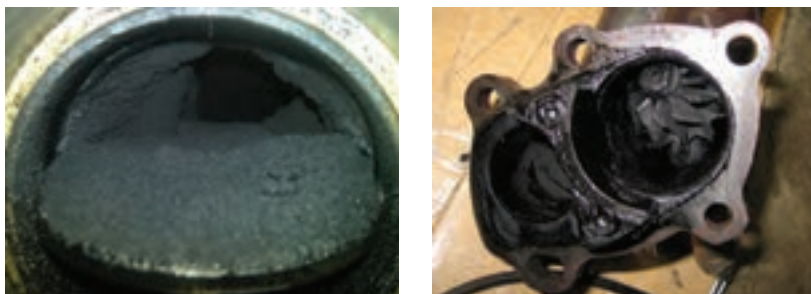
شکل ۸۸- رسوب کربن در ورودی و خروجی توربوشارژر
