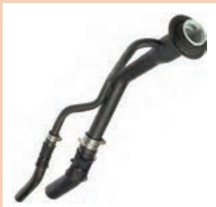
شکل ۳۷- لوله فلزی و شیلنگ پرکن مخزن
