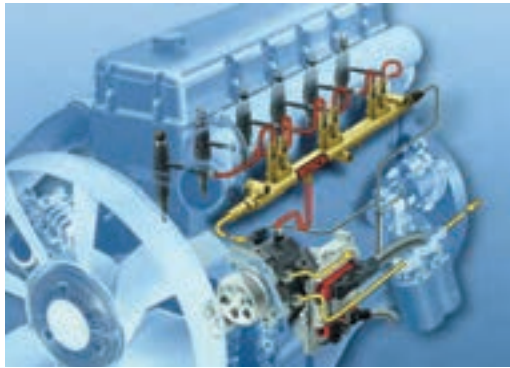
شکل ۲۹- موقعیت اجزای سیستم تزریق ریل مشترک بر روی موتور
