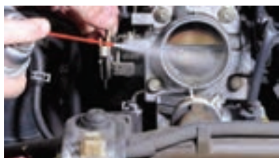
شکل ۸۲- سرویس دریچه گاز
