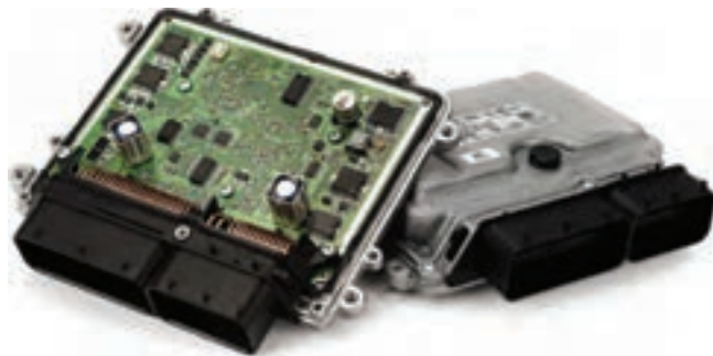
شکل ۱۹- یک نوع واحد کنترل الکترونیکی
