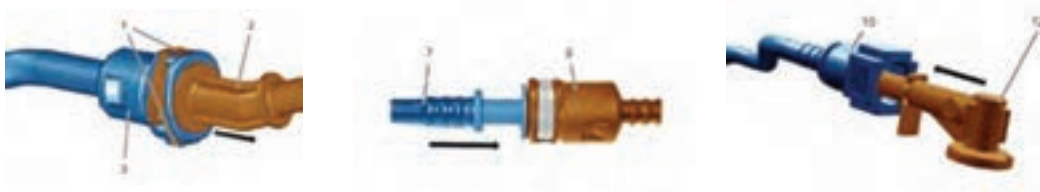
شکل ۷۴- نمونه‌ای از اتصالات سریع در مجموعه شیلنگ‌های سوخت
