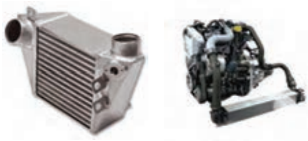
شکل ۳۶- واحد خنک کن هوای ورودی و محل قرارگیری آن
