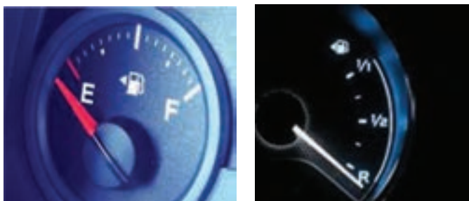
شکل ۱۴- نمایشگر سوخت آنالوگ (عقربه ای)
