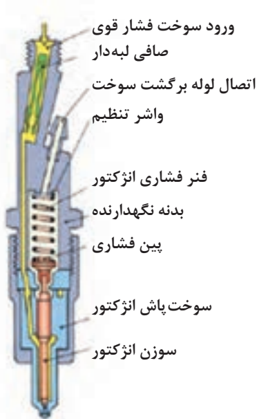
شکل ۲۵- مجموعه انژکتور دیزل
