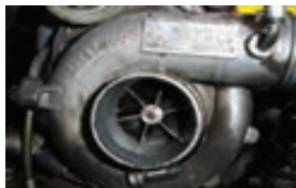
شکل ۸۷- نشت روغن در توربوشارژر
