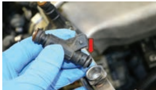
شکل ۷۱- انژکتور و اورینگ آن
