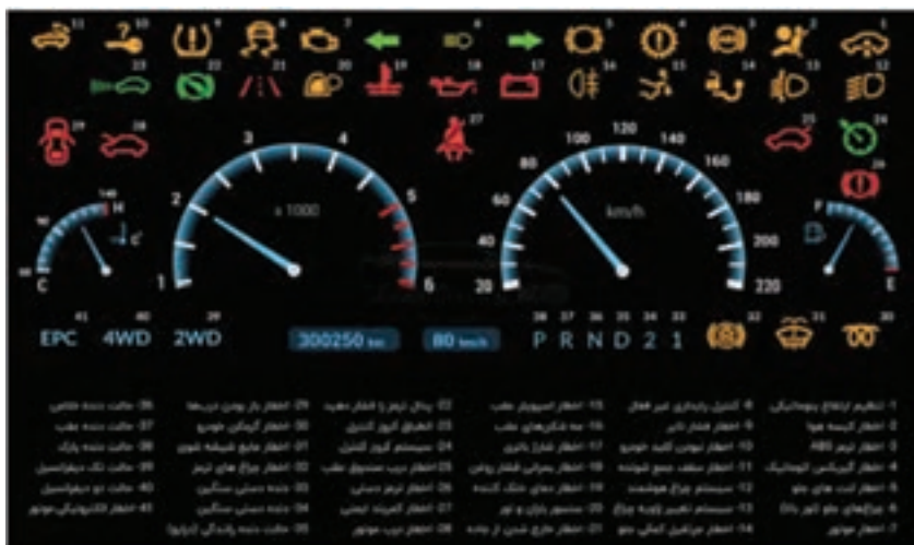
شکل ۷۹- تعدادی چراغ‌های هشدار و اخباری استفاده شده در خودروها
