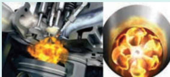
شکل ۴۳- فرم پاشش سوخت محفظه احتراق توسط انژکتور
