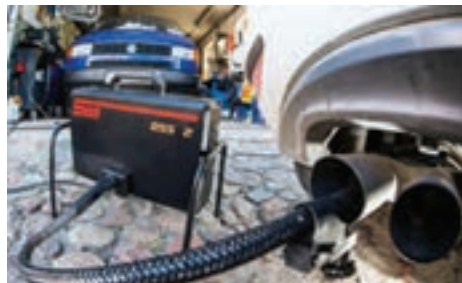
شکل ۶۱- قرار دادن لوله دستگاه کنترل آلاینده‌های درون لوله اگزوز
