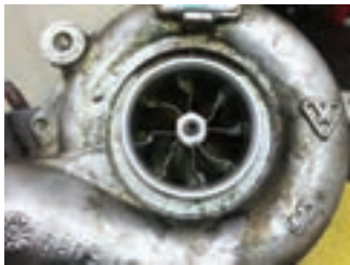
شکل ۸۶- خرابی پره‌های توربوشارژر در اثر برخورد با جسم خارجی
