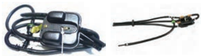
شکل ۶- ساختمان سیستم حباب گیر بنزین
