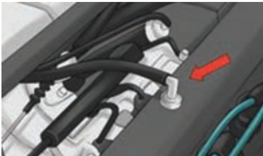
شکل ۱۱- سیستم کنترل آلاینده‌گی محفظه میل لنگ
