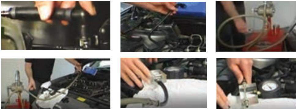
شکل ۵۴ - بازدید، بررسی و تعویض فیلتر سوخت
