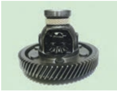
شکل ۵۸- چرخ دنده بسته شده روی دیفرانسیل
