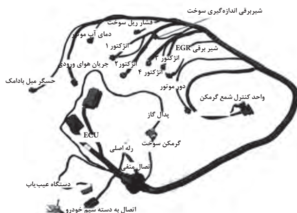
شکل ۷۳- دسته سیم یک نوع موتور دیزل با سیستم ریل مشترک
