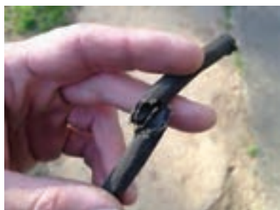
شکل ۵۲- یک نوع نشتی سیستم سوخت‌رسانی
