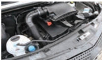
شکل ۹۷- محل های قرارگیری در مخزن مایع اگزوز دیزل
