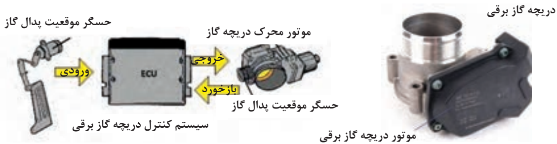
شکل ۳۱- دریچه گاز برقی و سیستم کنترل آن
