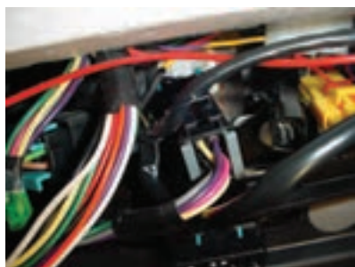
شکل ۵۳- بررسی چشمی اتصالات الکتریکی
