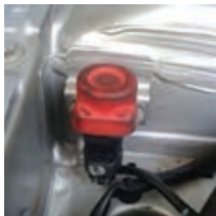
شکل ۲۳- یک نوع سوئیچ اینرسی
