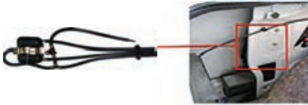
شکل ۴۶- بررسی مجموعه حباب‌گیر
