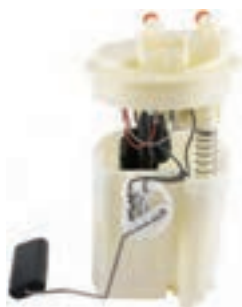
شکل ۲۲- مجموعه پمپ‌بنزین و شناور اندازه‌گیر مقدار سوخت داخل مخزن سوخت
