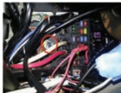
شکل ۵۳- بررسی چشمی اتصالات الکتریکی
