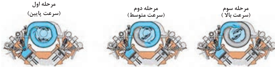
شکل ۴۲- عملکرد سیستم TUMBLE
