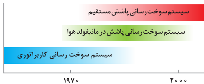
شکل ۴- تاریخچه انواع سیستم‌های سوخت‌رسانی
