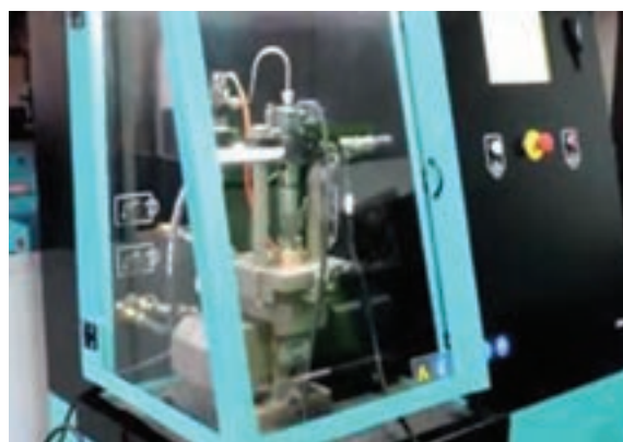
شکل ۷۰- برخی از مراحل آزمایش و تنظیم یک نوع پمپ واحد
