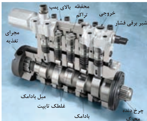
شکل ۲- یک نمونه پمپ انژکتور ردیفی
