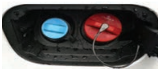
شکل ۹۷- محل های قرارگیری در مخزن مایع اگزوز دیزل
