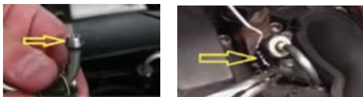
شکل ۵۹- برخی نکات نشتی یابی مدار سوخت رسانی
