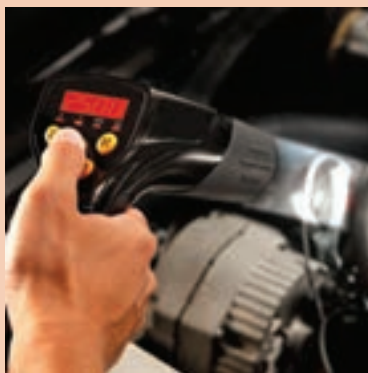
شکل ۲۱- روش کاربری چراغ تایمینگ
