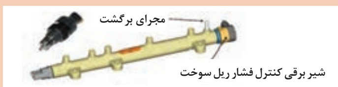
شکل ۳۸- سوپاپ کنترل فشار الکتریکی در تزریق ریل مشترک
