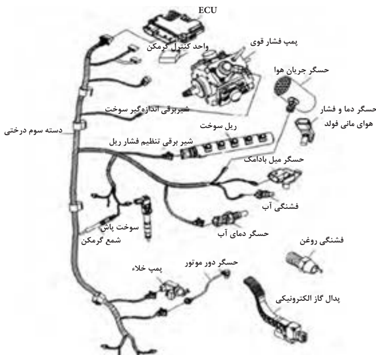
شکل ۷۷- نقشه درختی دسته سیم در یک نوع سیستم سوخت‌رسانی ریل مشترک
