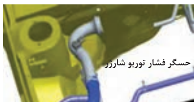
شکل ۳۲- موقعیت حسگر فشار توربو شارژر
