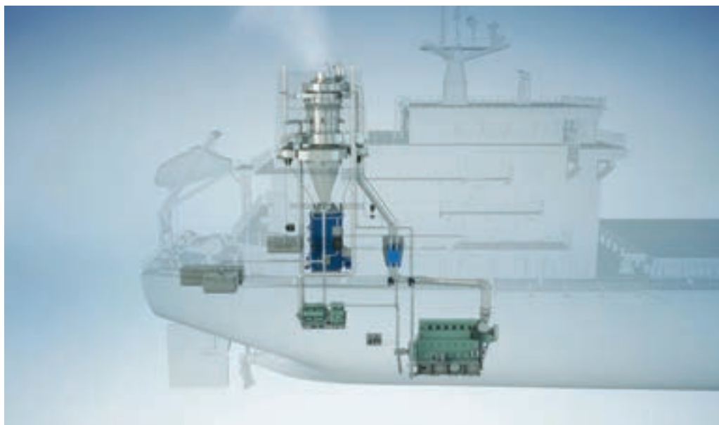
شکل ۲۶- نمایی از سامانه تخلیه دود یک کشتی
