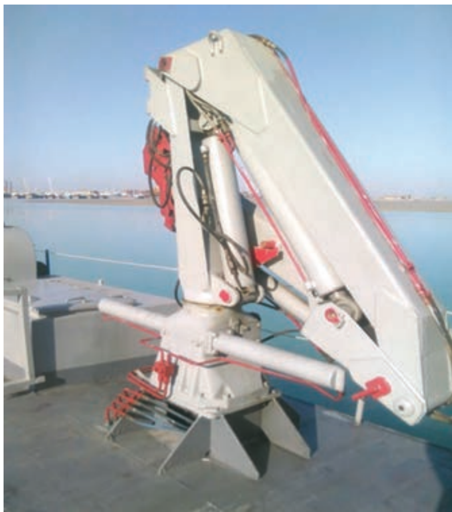
شکل ۲۲- جک هیدرولیکی بر عرشه یک شناور
