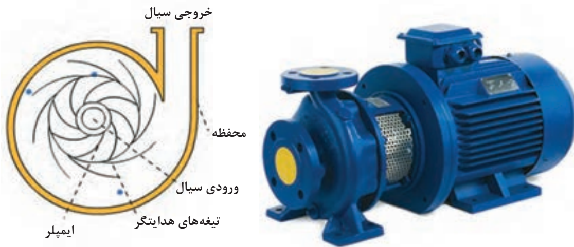
شکل ۵- پمپ گریز از مرکز
