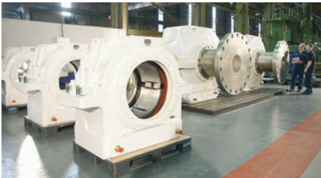
شکل ۲۴- یاتاقان‌های مورد استفاده جهت تکیه‌گاه محور پروانه
