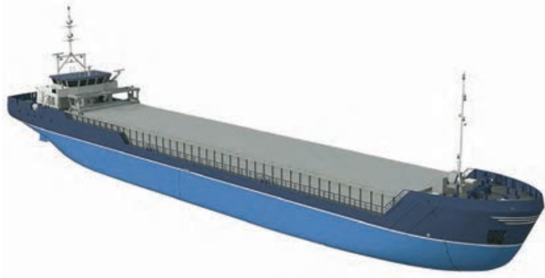
شکل ۱۰- سطح خیس شده شناور (ناحیه آبی‌رنگ)
