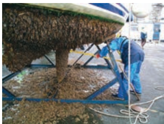
شکل ۲۳- چسبیدن خزه‌ها به بدنه شناور و پاک‌سازی آنها
