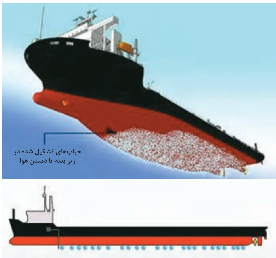
شکل ۲۲-دمیدن هوا در زیر بدنه شناور بجهت کاهش مقاومت شناور
