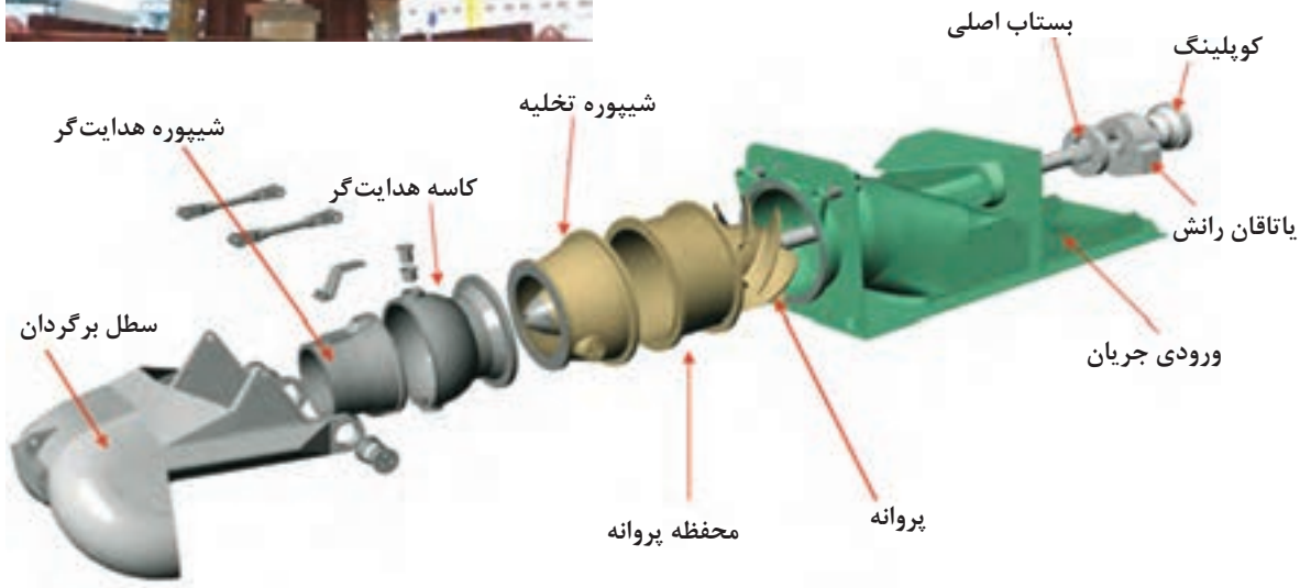
شکل ۵- سامانه رانش واترجت
