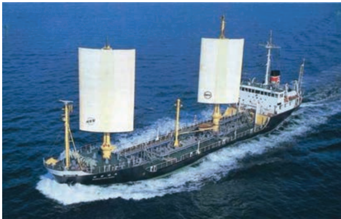
شکل ۴- استفاده از انرژی باد در حرکت کشتی‌ها
