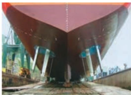
شکل ۲- سامانه پیش برنده وویس اشنايدر
