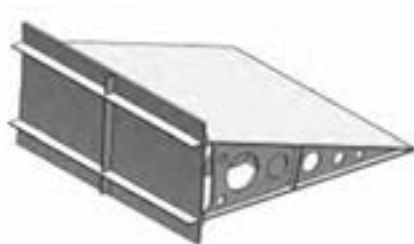
شکل ۲۷- بالچه تعادل مثلثی شکل
