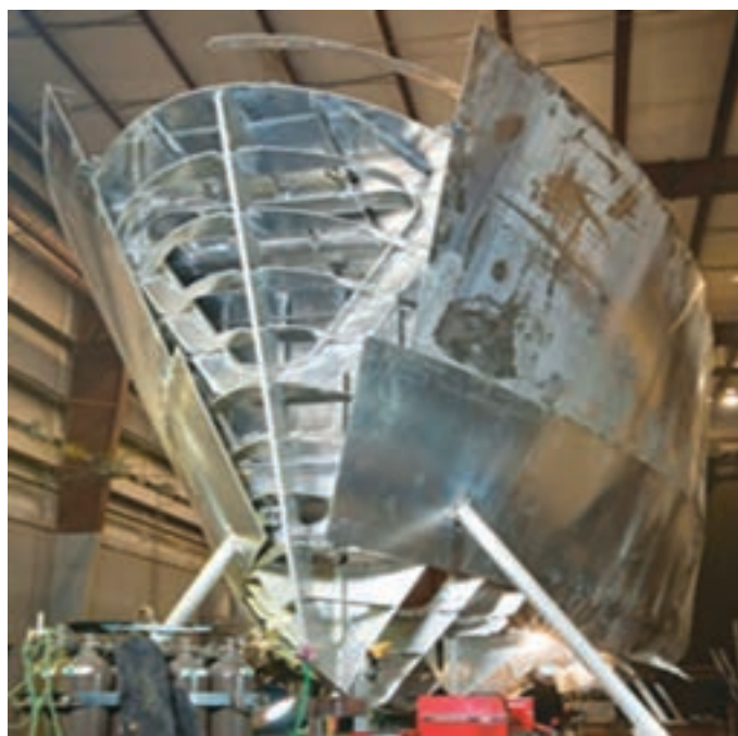
شکل ۲۳- سازهٔ سینهٔ یک شناور در حال ساخت
