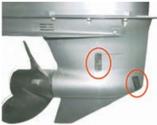
شکل ۳۰- ورودی های آب خنک کننده موتور
