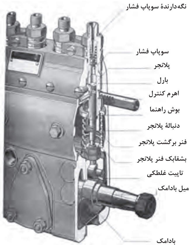
شکل ۳۱- پمپ انژکتور نوع جرک
