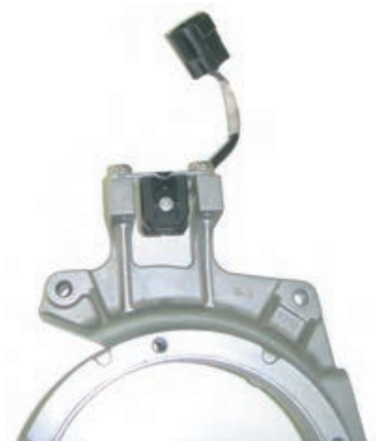
شکل ۱۶- حسگر موقعیت میل لنگ
