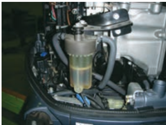
شکل ۴- پالایه اولیه سوخت
