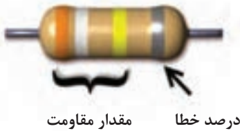
انواع مقاومت ثابت
