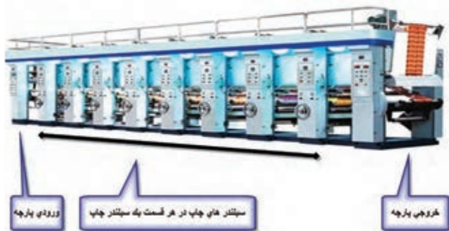
شکل ۸- نمای عملکرد ماشین چاپ غلتکی افقی
