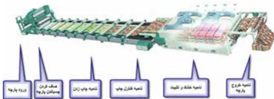
شکل ۶- نمای عملکرد ماشین اسکرین تخت اتوماتیک
