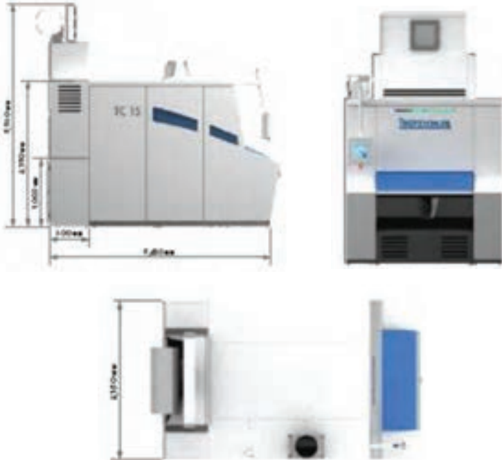
شکل ۶ - پلان ماشین کاردینگ و اطلاعات فنی
