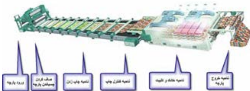
شکل ۶- نمای عملکرد ماشین اسکرین تخت اتوماتیک
