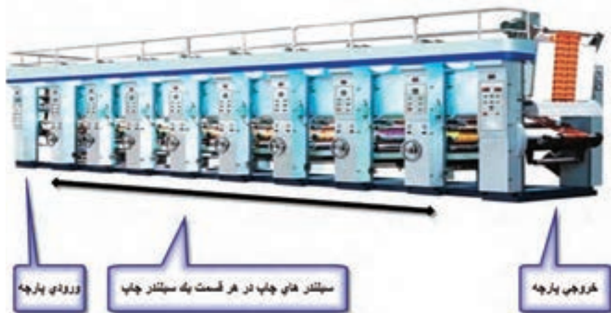
شکل ۸- نمای عملکرد ماشین چاپ غلتکی افقی
