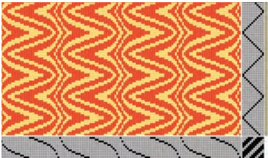
شکل ۳۷: طرح ایجاد انحنا در سرژه با تغییر در نخ‌کشی و نقشه تکرار پودی
