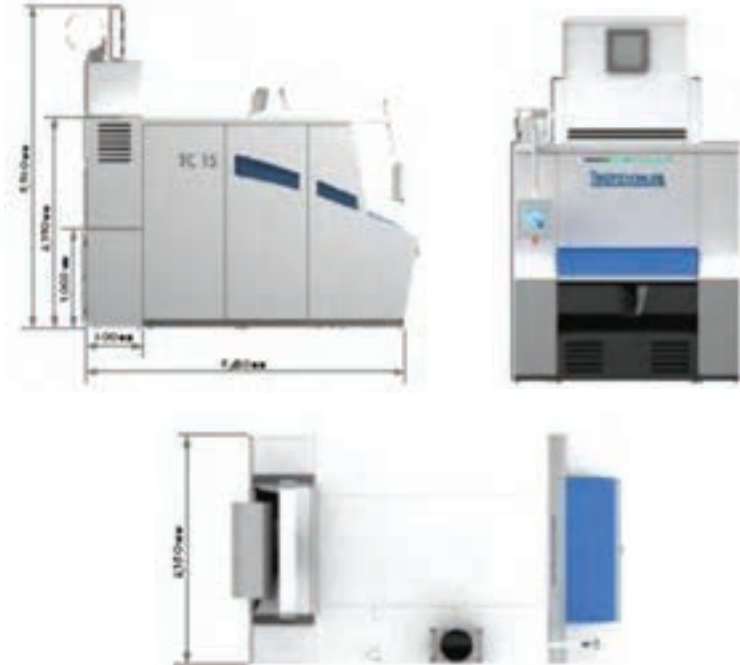
شکل ۶ - پلان ماشین کاردینگ و اطلاعات فنی
