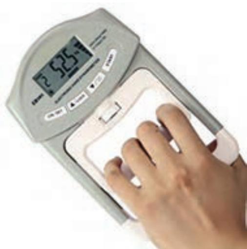
تصویر اندازه‌گیری قدرت عضلات دست با دینامومتر
