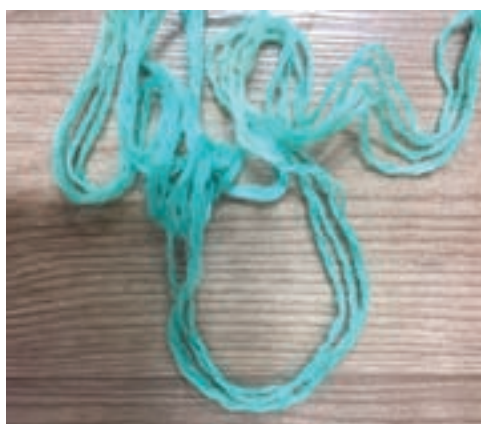
رنگرزی نامرغوب نخ
