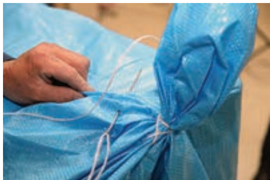
شکل ۸۰- جمع کردن گوشه‌های دهانه و دوختن آنها
