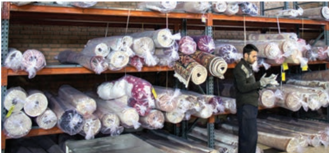
شکل ۹- بسته‌بندی فرش در کارگاه قالیشویی با استفاده از کیسه نایلونی شفاف
