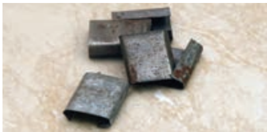
شکل ۲۵- بست فلزی مخصوص نوارکشی
