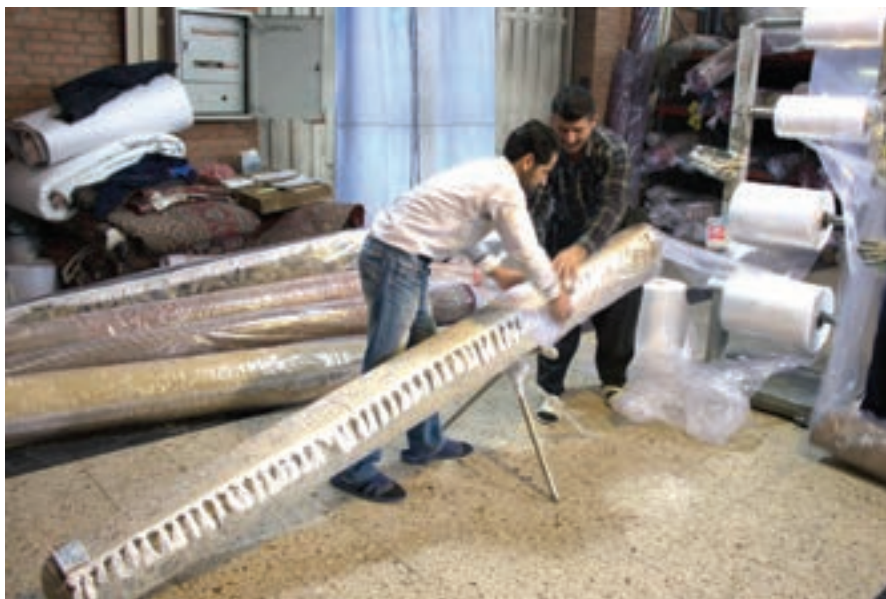
شکل ۱۵- استفاده از خرک و پایه رول برای بالا نگه داشتن فرش و روکش کردن آن
