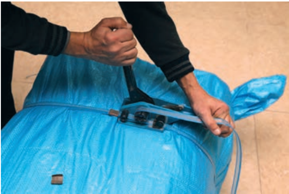
شکل ۲۲- نوارکشی روی بسته با نوار پلاستیکی
