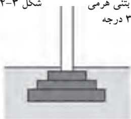
شکل ۳-۴۶ پی بتنی پلکانی با زاویه‌ی ۴۵ درجه
