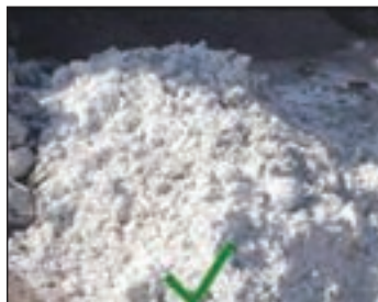
شکل ۳-۳۶ آهک سرنده (آهک) شده و آماده برای ساخت شفته
